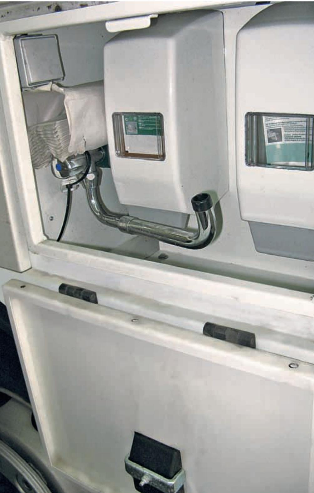
Das Fahrzeug ist mit einer Handwascheinrichtung sowie Desinfektions- und Seifenspender ausgestattet. Auch dadurch wird die Infektionsgefährdung durch Bakterien reduziert.
