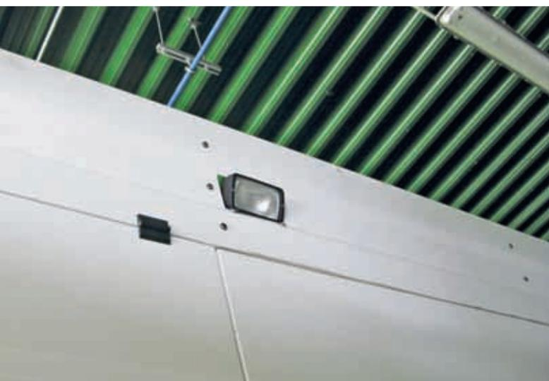
Eine Umgebungsbeleuchtung über den Seitenflächen des Fahrzeugs leuchtet den Arbeitsbereich hinter dem Fahrzeug aus und macht die Bewegungsbereiche zu den Pumpen besser sichtbar.
