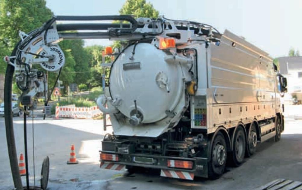
Heckansicht eines Hochdruckspülfahrzeugs mit Wasseraufbereitung
